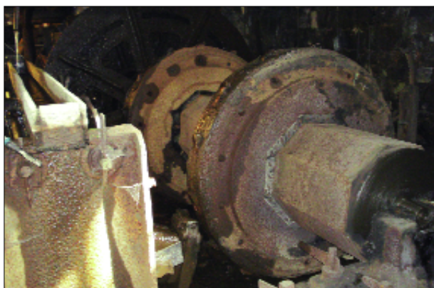
Fig. 2 : Arbre à deux roues camées entraînant les deux marteaux d'étirage et platinage
