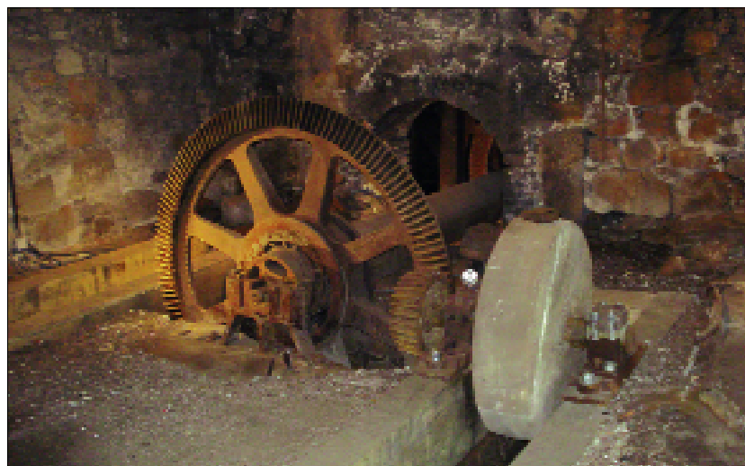
Fig. 1 : Meule de façonnage des têtes de marteau de platinage
