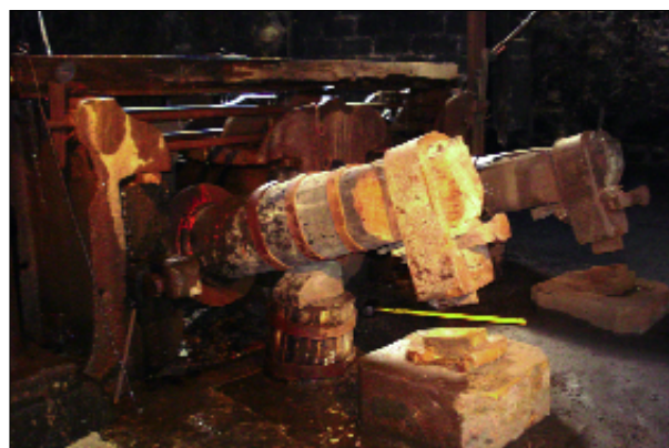
Fig. 3 : Marteaux d'étirage et de platinage
