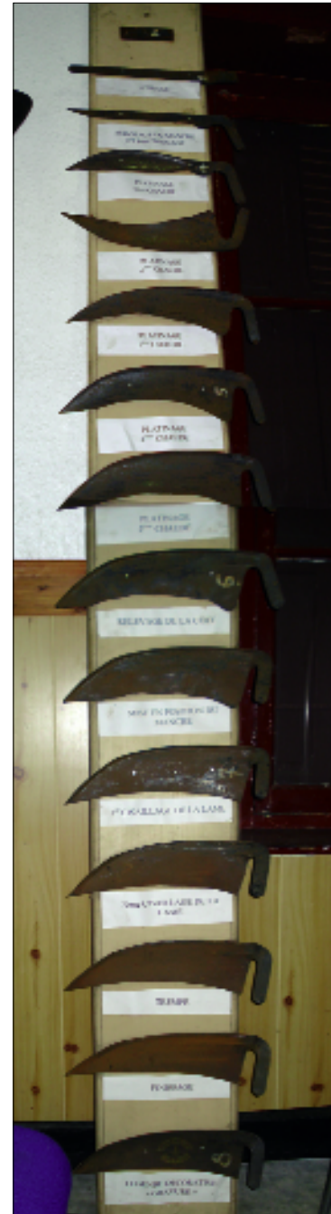
Fig. 5 : La métamorphose du lopin ou la naissance d'une faux
